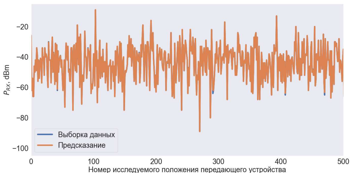
Рисунок 82. Сравнение экспериментальных данных и прогнозирования RSSI передатчиков в различных точках для XBee 3.0 методом регрессии случайного леса
