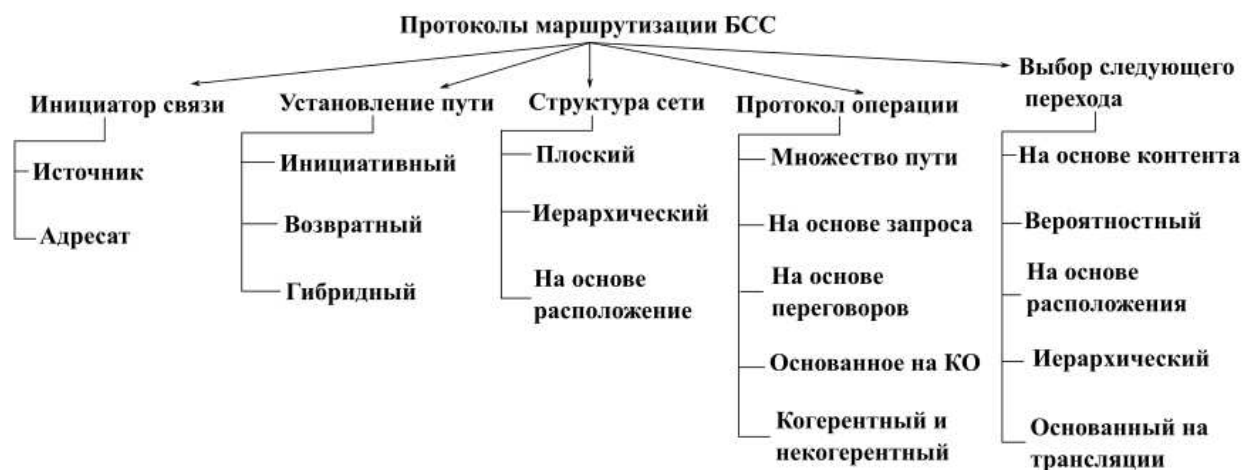
Рисунок 8. Классификация протоколов маршрутизации
