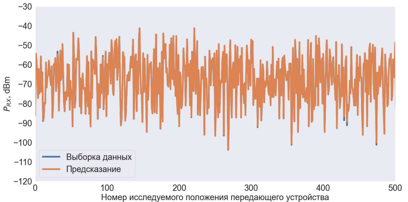
Рисунок 76. Сравнение экспериментальных данных и прогнозирования RSSI передатчиков в различных точках для LoRa Ra01 методом регрессии случайного леса
